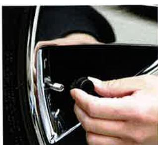
約8.8gのセンサー部を既存のバルブキャップと交換するだけで設置完了。センサー通信は国際電波法に適合した電波を使用している。
