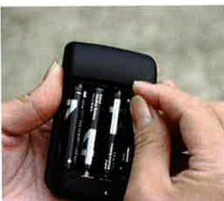
レシーバーの電源は単4電池×4本。クルマの振動停止から10分経つとスリープ状態になる節約機能も装備。電源はシガープラグ(付属)でも可能。
